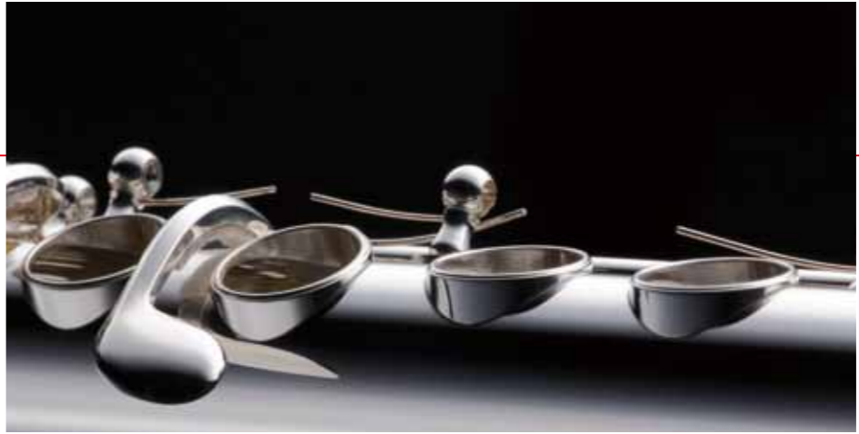
ソルダード・トーンホール トーンホールは管体よりも厚みのある銀の筒を溶接（ハンダ付け）する。
