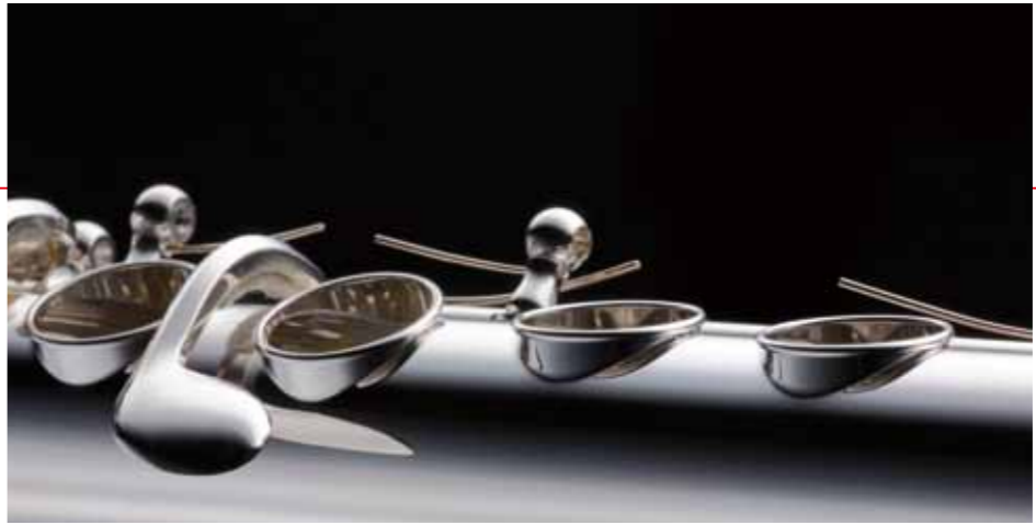
ドローン・トーンホール トーンホールは管体から引き上げ、先端をカーリング加工する。
